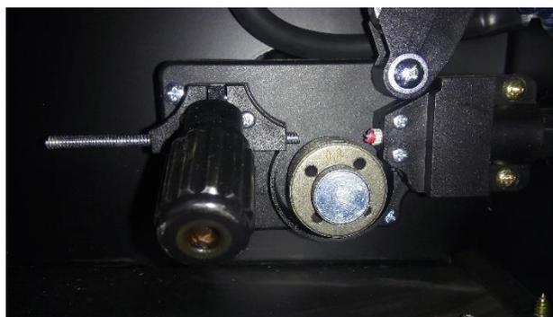
6. Revise que la polaridad en la antorcha sea la indicada para trabajar el micro alambré, en caso de necesitar modificar el polo asegúrese primero de apagar el equipo después afloje la
