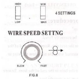
Al alternar los ajustes debemos recordar incrementar o reducir la velocidad del cable para poder trabajar la soldadura. En materiales desde 0.6mm hasta 1.3mm seleccione los ajustes de "Min" y para materiales más gruesos, seleccione "Max".
