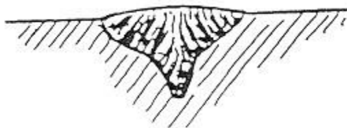
Aspecto de cordón de soldadura usando Argón
