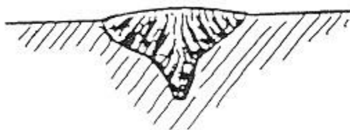
Aspecto de cordón de soldadura usando Argón
