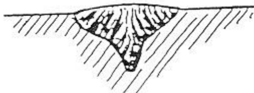
Aspecto de cordón de soldadura usando Argón
