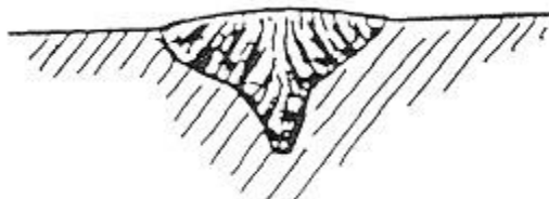
Aspecto de cordón de soldadura usando Argón
