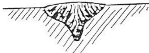
Aspecto de cordón de soldadura usando Argón
