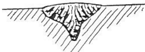
Aspecto de cordón de soldadura usando Argón
